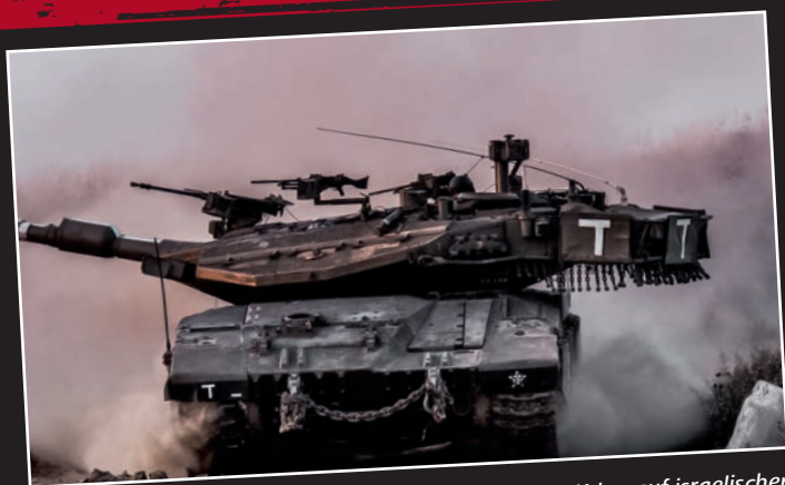
Crew Survivability: Eine Lektion aus dem Yom-Kippur-Krieg auf israelischer Seite war die Erkenntnis, daß Panzerbesatzungen schwerer zu ersetzen sind als Panzer. Deshalb unterscheidet sich Israels Post-Yom-Kippur Hauptkampfpanzer „Merkava“ schon im Grunddesign signifikant von allen anderen modernen Kampfpanzern
