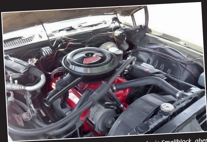
GM 400: Sieht aus wie ein Smallblock, und ist auch ein Smallblock, aber eben nicht ganz genau der Smallblock... GMs „großer Kleiner“ erreichte Bigblock-Hubraum in Smallblock-Verpackung – mit allen denkbaren Nachteilen einer solchen Konstruktion
