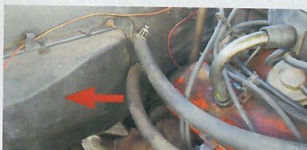
Unter dieser Abdeckung sitzt der Wärmetauscher. Ist er undicht, müssen Kotflügel und Radkasten weg
