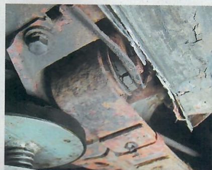
Korrosion an der Verschraubung der Blattfeder-Aufnahme kann hohe Kosten nach sich ziehen
