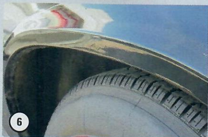
6 Die Radläufe sind wie bei nahezu allen alten Autos anfällig für Rostschäden
