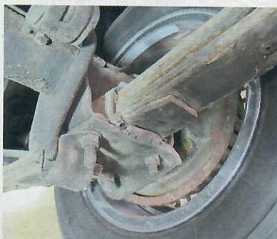
Die Trommelbremsen geben selten Anlass zur Beschwerde, Teile sind gut verfügbar
