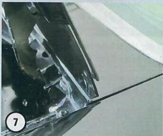
Das Blech zwischen Heckscheibe und -klappe ist nur geschraubt
