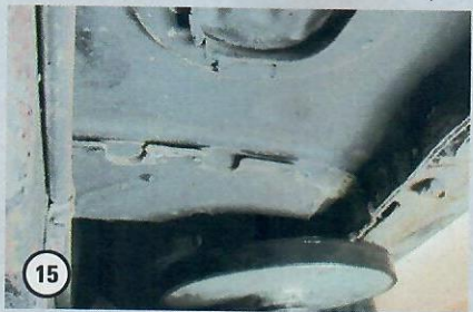
15 Im vorderen Bereich der Bodenbleche nistet der Gilb gerne in diesem Falz
