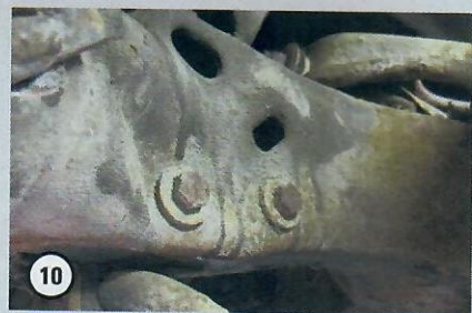
10 Dreck rund um die Stützhülsen der Lenkgetriebeschrauben führt zu Rostschäden im Rahmen
