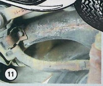
Beifahrerseite: Der Hilfsrahmen leidet unter austretender Batteriesäure
