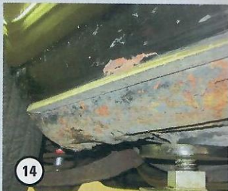
Rost im unteren Bereich der Kotflügel kommt häufig vor
