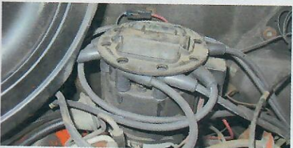
Modelle ab 1974 sind mit einer kontaktlosen Zündanlage ausgerüstet. Sie ist unzerstörbar
