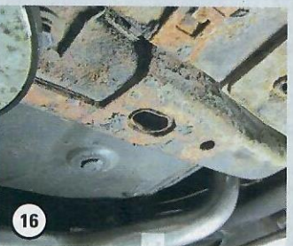
Ein Fall für den Profi: Rostschäden in den hinteren Rahmenbögen
