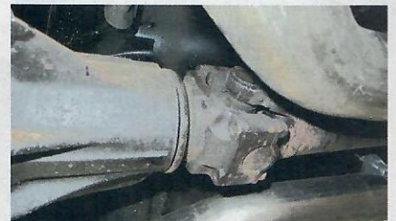
Die Kreuzgelenke sind robust, können aber durch getunte Motoren schneller verschleifen
