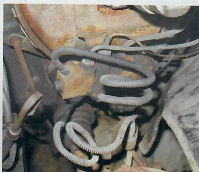
Der Bremsdruckregler im Motorraum gammelt häufiger fest
