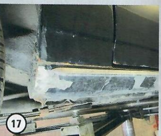
Korrosion an den Türkanten und dem Übergang vom Seitenteil...
