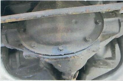
Die Hinterachsen sind eigentlich unzerstörbar, schwitzen aber fast immer
