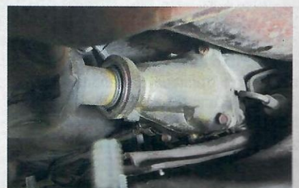
Die Dichtung am Getriebeausgang steht denen vom Motor in nichts nach: Auch sie leckt
