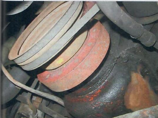
Ölverlust am vorderen und hinteren Simmerring der Kurbelwelle ist ein verbreitetes Übel
