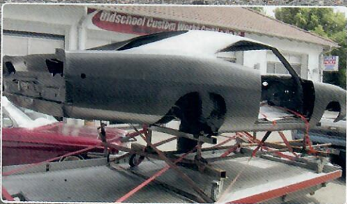
Untergetaucht: Nach Karosseriearbeiten und Säurebad wurde die Karosserie Tauchbadgründiert
