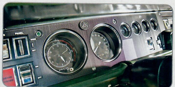
Schalten um Viertel nach Zwölf: In die Uhr integrierter „Tic Toc Tach“-Drehzahlmesser neben 150 mph-Tacho
