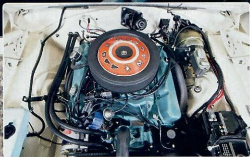
Verhältnismäßig: Der gewaltige 7,2-Liter V8 harmoniert perfekt mit dem Charger-Motorraum
